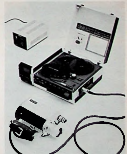
Stand 19 Complete draagbare videoinstallatie voor opnamen en weergeven Akai-VTS100 .
